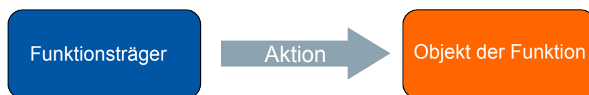
Bild 5.14 Schema der Funktionsformulierung nach [3]
